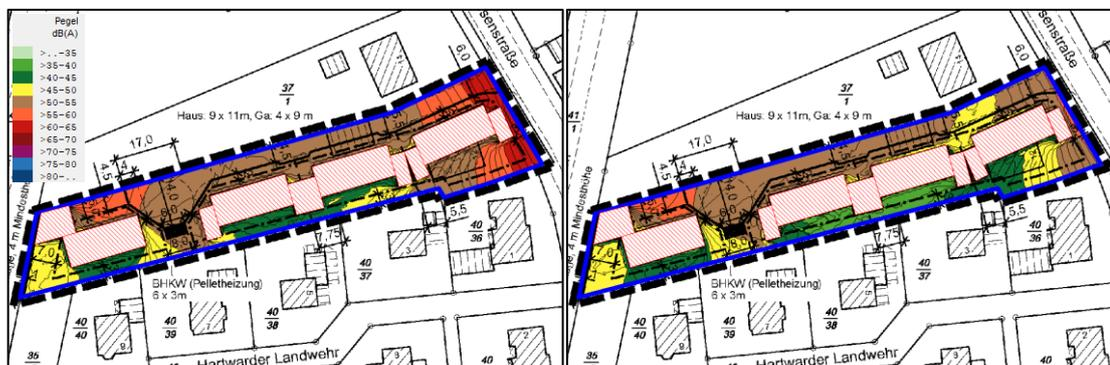
Abbildung 5 Immissionsraster 2 m über GOK mit möglicher Bebauung
