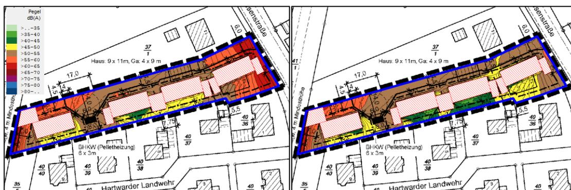
Abbildung 6 Immissionsraster 5 m über GOK mit möglicher Bebauung
