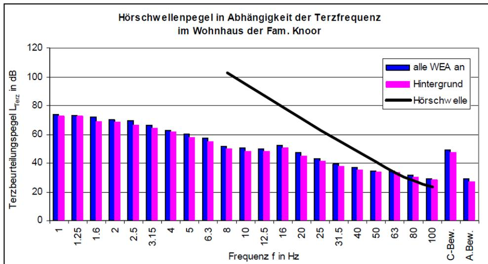
Abbildung 2: Ergebnisse der Immissionsmessung durch Kötter Consulting Engineers /11/
