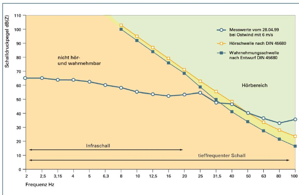
**Abbildung 1: Messung des Infraschallpegels in 250 m Entfernung einer Nordex N54 (LfU Bayern 2014 /7/)**
